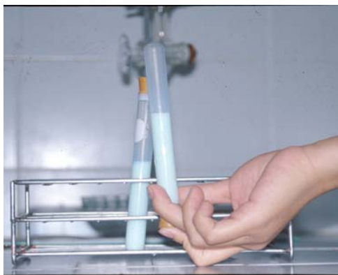
➤ การตรวจหาแบคทีเรียที่ปนเปื้อนในน้ำนม โดยวิธีเมทาซิทินบลู
